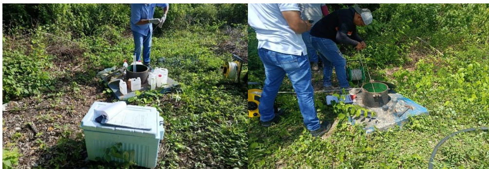
Ilustración 51. Mantenimiento piezómetro 52-II-B-PZ-01A: Fuente. Oficina de Aguas Subterráneas, 2025
