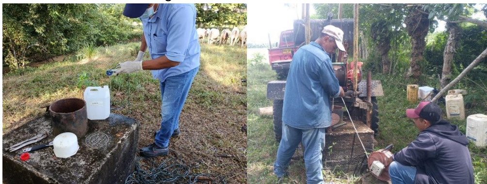
Ilustración 53. Mantenimiento piezómetro 52-II-A-PZ-02: Fuente. Oficina de Aguas Subterráneas, 2025
